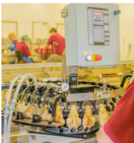
Photo : Epointage par la méthode infra-rouge
