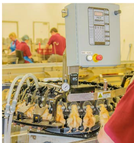
Photo : Epoutage par la méthode infra-rouge
